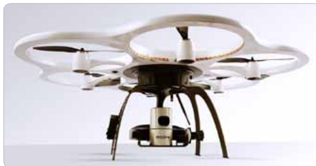
Obr. 3 Dron vybavený 3D laserovým skenerom LiDAR [4]
