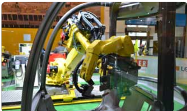
Obr. 13 Spoločnosť FANUC predstavila v rámci aplikácie zvárania zaujímavé riešenie – umiestnenie menšieho robota na koncový bod väčšieho.
