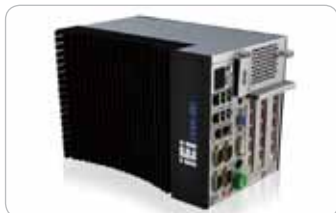
Obr. 2 Priemyselný počítač TANK-820 od spoločnosti iEi Integration
