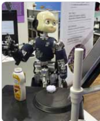
Obr. 9 Robot iCub obsahuje až 53 motorov
