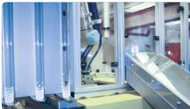
Obr. 3 UR robot je v spoločnosti Oticon bezpečne prichytený na vstrekovacom lise, pričom sa môže pohybovať ponad formu a vyťahovať plastové predmety. Dokáže to vďaka špeciálne navrhnutému vákuovému systému, ktorý zabezpečí, že ani krehké výrobky sa nezničia.
