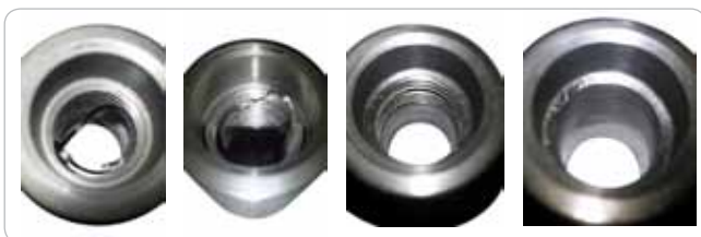
Obr. 1 Poškodené vnútorné závitú
