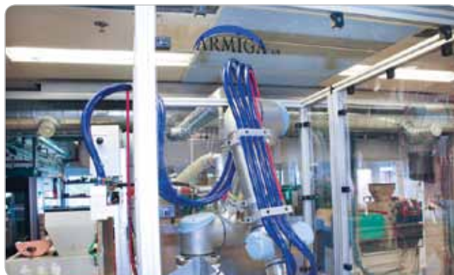
Obr. 2 Výrobca načúvacích prístrojov Oticon používa robot UR5 na rôzne úlohy v oblasti odlievania, keď je nástroj nasávania nahradený pneumatickým uchopovacím nástrojom na manipuláciu so zložitejšími odliatymi kusmi. Šestosťový robot pracuje v cykle 4 – 7 sekúnd, vykonáva naklápanie a preklápanie, ktoré dvoj- a trojosové roboty nasadené v Oticon v minulosti neboli schopné vykonávať.
