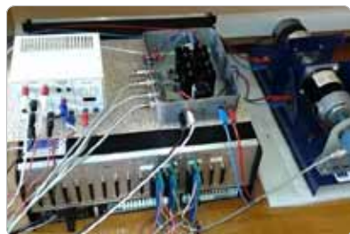
Obr. 3 Realizačné pracovisko s testovaným motorom a dynamometrom
