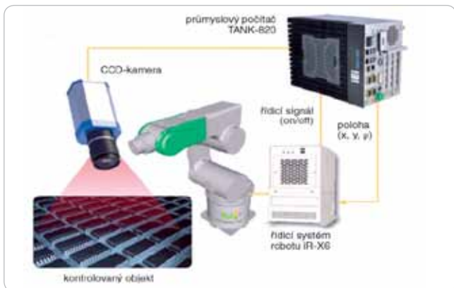
Obr. 1 Systém strojového videnia v kombinácii s ovládaním robotu
