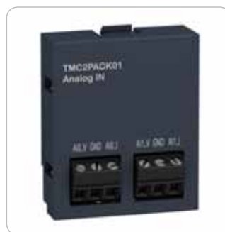
Obr. 3 Zásuvné moduly sa inštalujú priamo do tela PLC a rozširujú možnosti Modicon M221 o ďalšie 2 analógové vstupy.
